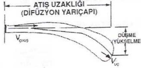
Şekil 2.20. Menfezin Hava Atış Uzaklığı ve Düşmesi
